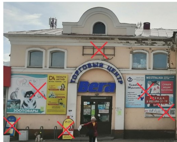
Штендеры; баннеры; не используемый каркас для вывески; каркас вывесок без подложки выполнен не в тон фасадных элементов; главная вывеска не сомасштабна арочному проёму; стекло двери заклеено информационными носителями.
